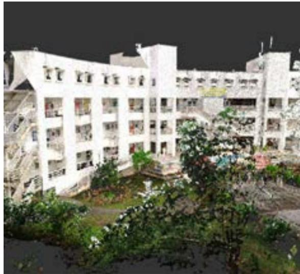
Nuvem de pontos obtida através do levantamento com scanner a laser.
